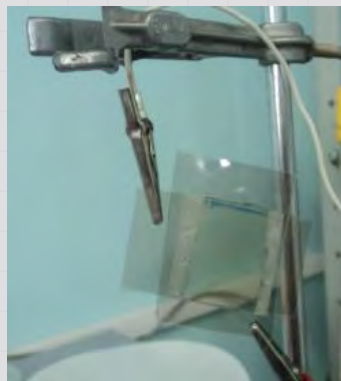
Фрагмент плёнки после нанесения покрытия TiN
