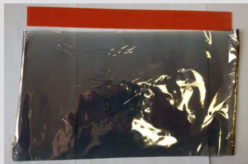
Внешний вид плёнки с покрытием TiN
